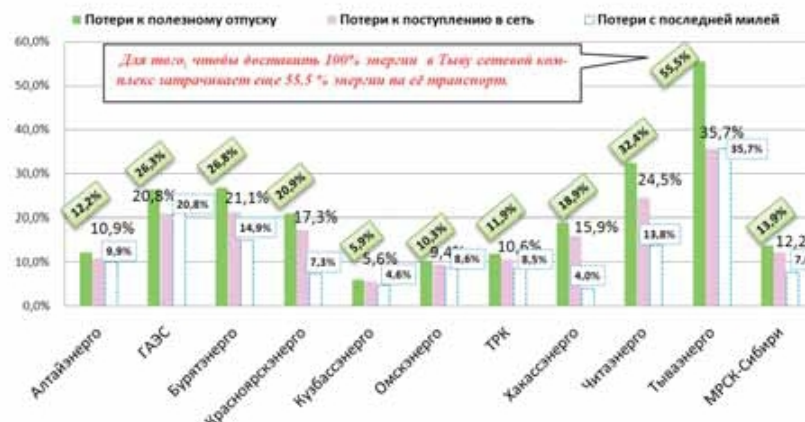
Рис 2 Процент потерь электроэнергии в сети в 2009г [%]
