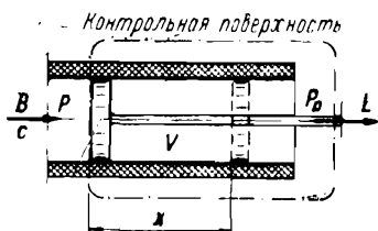
Рис. 16. Модель для определения эксергии однородной части системы, заключенной внутри контрольной поверхности.
