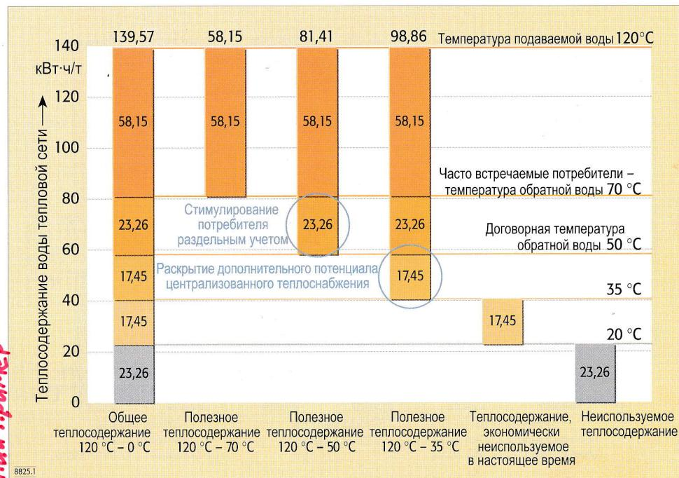
**Рис. 1.** Полезное теплосодержание 1 т воды в тепловой сети при различном перепаде температур подаваемой и обратной воды
